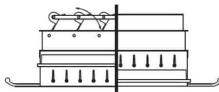
Rysunek 3. Przepustnica regulacyjna współbieżna.
